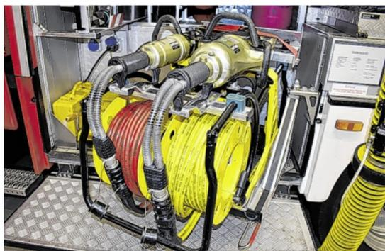
Das Rettungsgerät der Ostrhauderfehner Wehr: Links ist das Schneidegerät, rechts der Spreizer. Beides soll demnächst erneuert werden.
